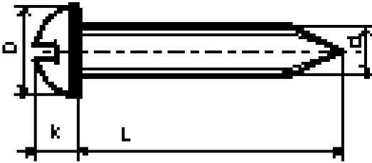
Винты самонарезающие с полупотайной головкой и заостренным концом для металла и пластмассы. **ГОСТ 11651-80**
